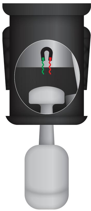
**VERRIEGELUNG** SPERRT DEN PIN IM VERSCHLUSS
